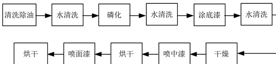
清洗除油采用氢氧化钠和合成洗涤剂；磷化使用磷酸锌、硝酸镍；底漆使用不含铅的水溶性涂料；中漆和面漆含甲苯、二甲苯；烘干采用热空气加热方式。
